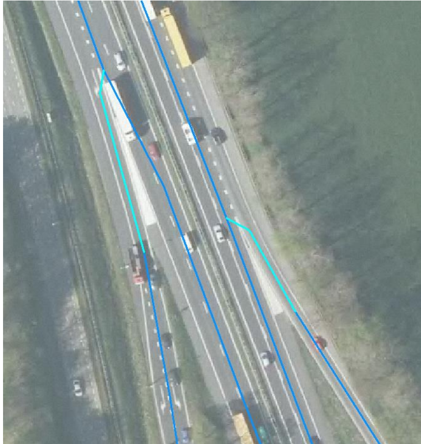
Figuur 7.2 De baansubsoort puntstuk is opgelicht.
